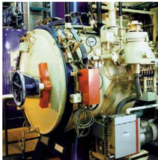
Abb.: Materialprüfung und -härtung „Tiefkühlen mit Flüssigstickstoff“
