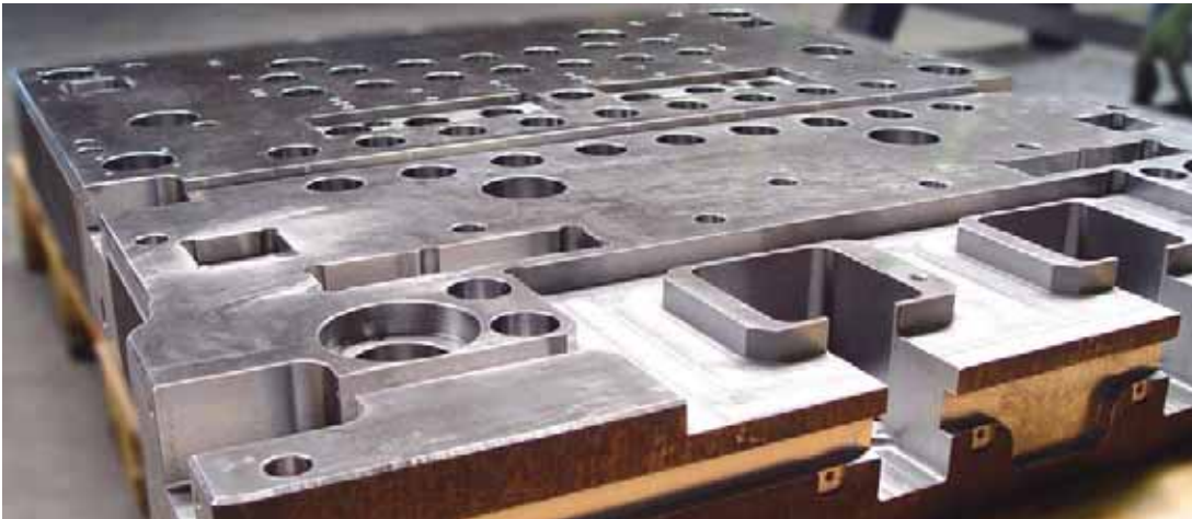
Abb.: Werkzeug zur Herstellung von Heizungsradiatorenblechen
