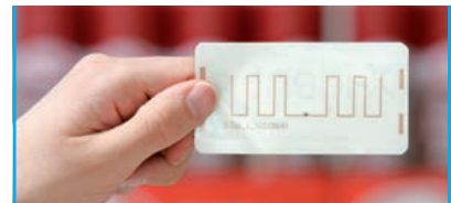
RFID-Transponder: sicht- und kontaktlose Datenübertragung
